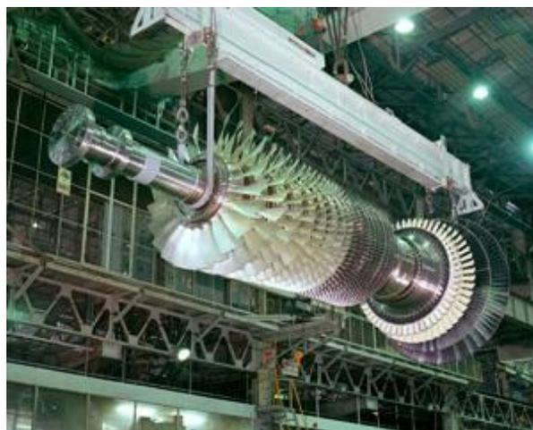
火力発電所のタービン (北陸電力 HP より)
