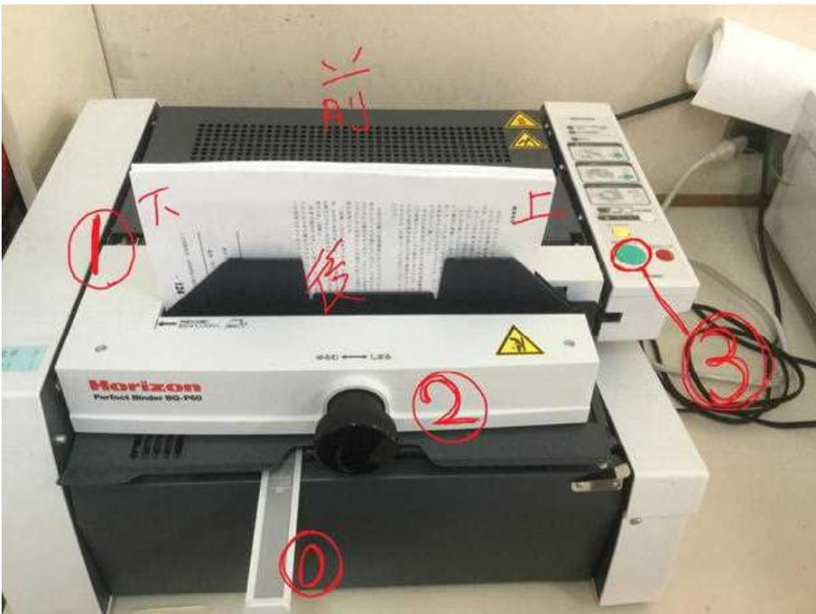
\* 準備の時に、①を使い表紙の位置を決めます。そのあと、特集号の中身を揃えて①にセットします。(向き大事) セットが終わると②を締めて、中身が動かないように固定します。最後に③のスタートボタンを押します。
